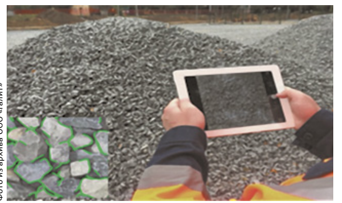
Так работает программный комплекс, определяющий размер фракций щебня
