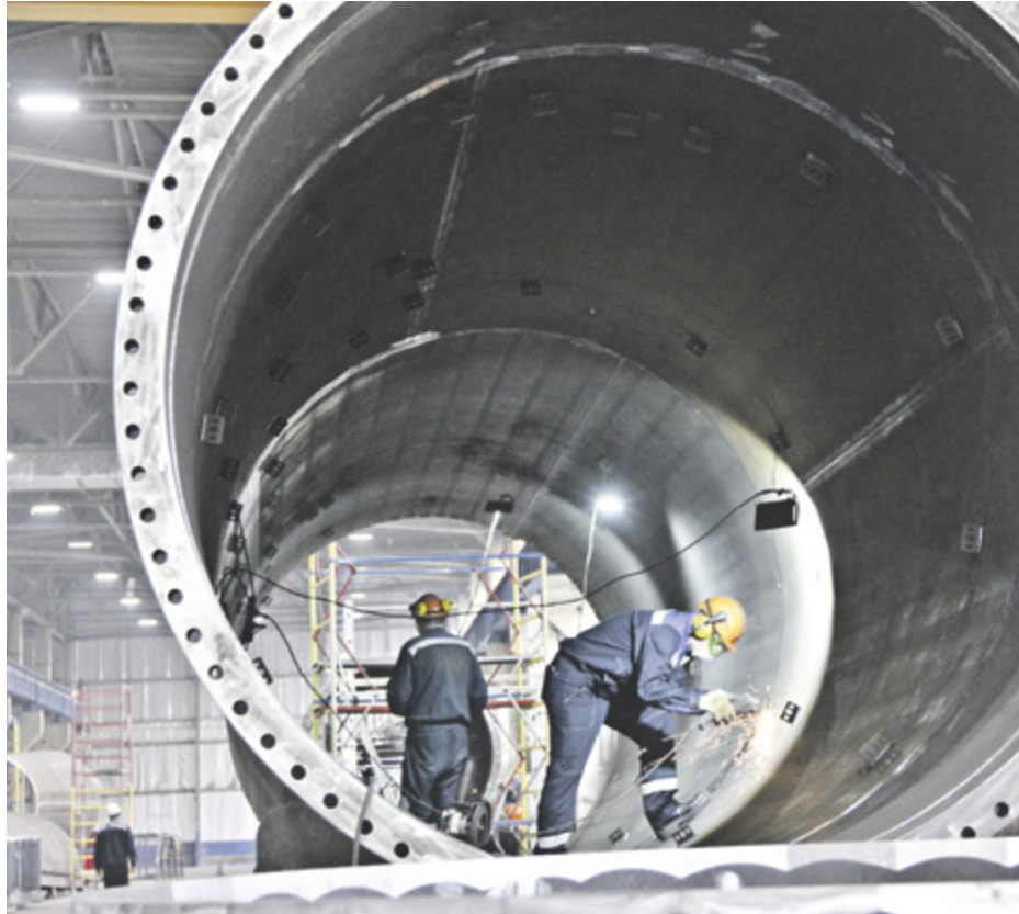
■ Верхняя секция опоры ВЭС составляет 18 м в длину, а диаметр основания – 3,2 м
