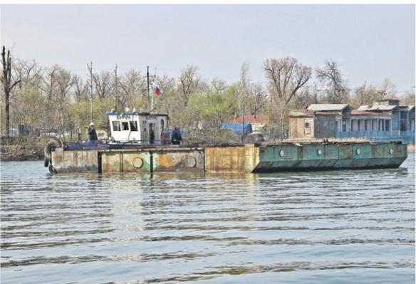
■ Катер «Бурун» буксирует две понтонные секции вниз по Дону
