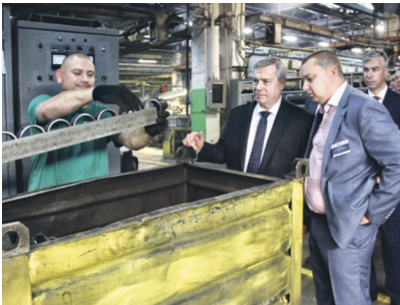
■ Рабочий предприятия «10-ГПЗ» демонстрирует донскому губернатору Василию Голубеву наружные кольца подшипников, прошедшие процесс закалки
