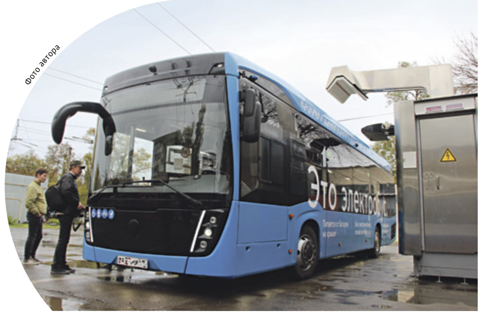
■ Зарядная станция для нового вида транспорта – полностью отечественной сборки. Она восполняет до 80% емкости батареи электробуса за 20 минут
