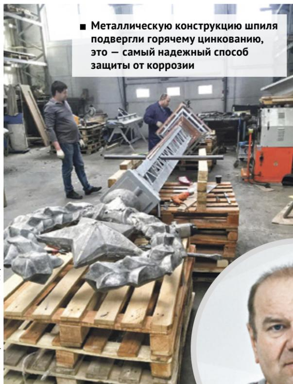
■ Металлическую конструкцию шпиля подвергли горячему цинкованию, это – самый надежный способ защиты от коррозии
