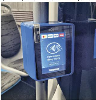
По задумке разработчиков, в случае удачного завершения тестирования новые терминалы можно будет размещать не только у водителя, а сразу у всех дверей общественного транспорта, что значительно сократит время стоянки на остановках. Одновременно возможно подключение до трех выносных устройств.
