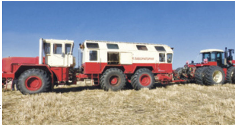
■ Испытание тяговой лабораторией проходят не все тракторы, а только опытные образцы
