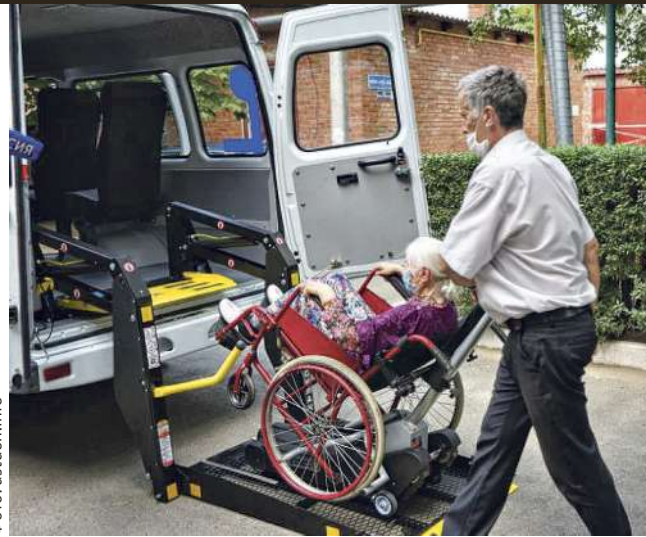
■ Так работает подъемник социального такси, с помощью которого человека в инвалидной коляске размещают в салоне автомобиля
