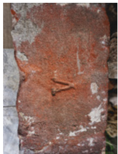
■ Кирпичи, найденные на руинах дома начальника Ростовского водоканала, с клеймом кирпичного завода Леванидова
