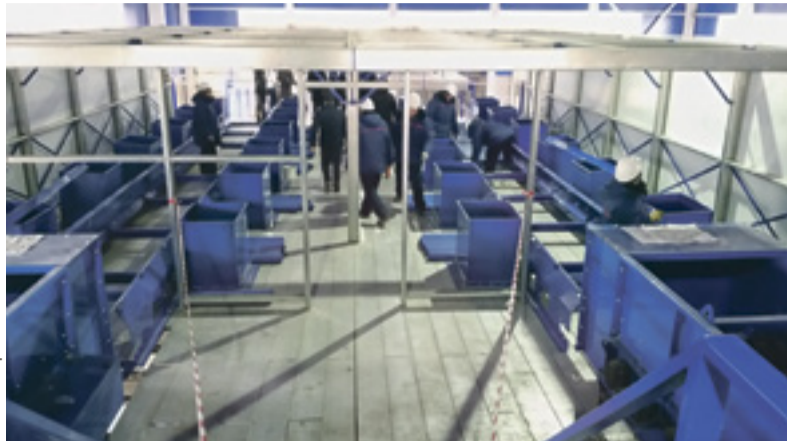
После ручной сортировки ТКО попадают в оптические сепараторы, где происходит отделение нужных фракций
