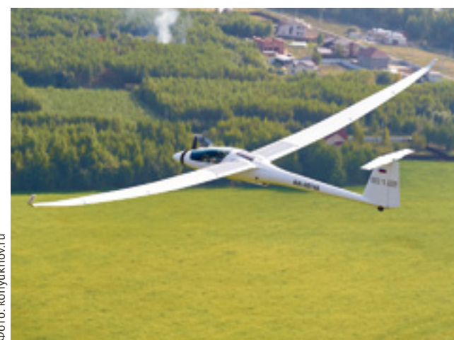
■ Размах крыла этого самолета-планера – 26,5 метра
